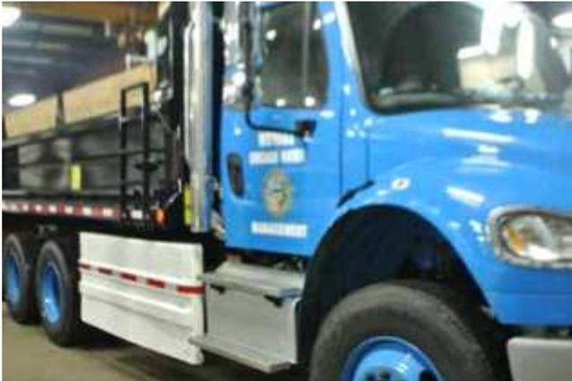
트럭 측면 보호대는 차량의 뒷바퀴 아래에 장애물을 추가하여 사람이 걸거나 자전거를 타는 경우 충돌 위험을 줄인다. 여기에 표시된 차량 측면의 흰색과 빨간색 구
